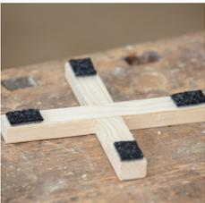
Damit keine Kratzer auf Möbelstücken entstehen, können auf der Unterseite Teppichreste angeleimt werden. Für das Rundholz wird in der Mitte des Kreuzes ein Loch (1 cm Durchmesser) gebohrt, wo anschliessend der Mittelstab ebenfalls mit etwas Leim eingesteckt wird.
