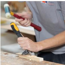
Für den Fuss werden zwei Hölzer zurechtgesägt. In beide Teile wird mit dem Stechbeutel eine durchgehende Furche bis in die Mitte ausgehoben. Mit der Zugabe von etwas Holzleim werden die beiden Hölzer dann zusammengesteckt.
