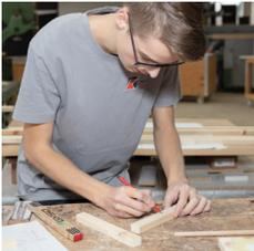
Die Kanthölzer gemäss der Skizze (Seite 2) bezeichnen, das nächstfolgende Holz ist immer um 6mm kürzer. Mit der Hand- oder Stichsäge in die angezeichnete Länge kürzen. Zusätzlich zwei kleine Stücke 20 x 20 mm für den Stamm. Die gesägten Kanten leicht abschleifen.
